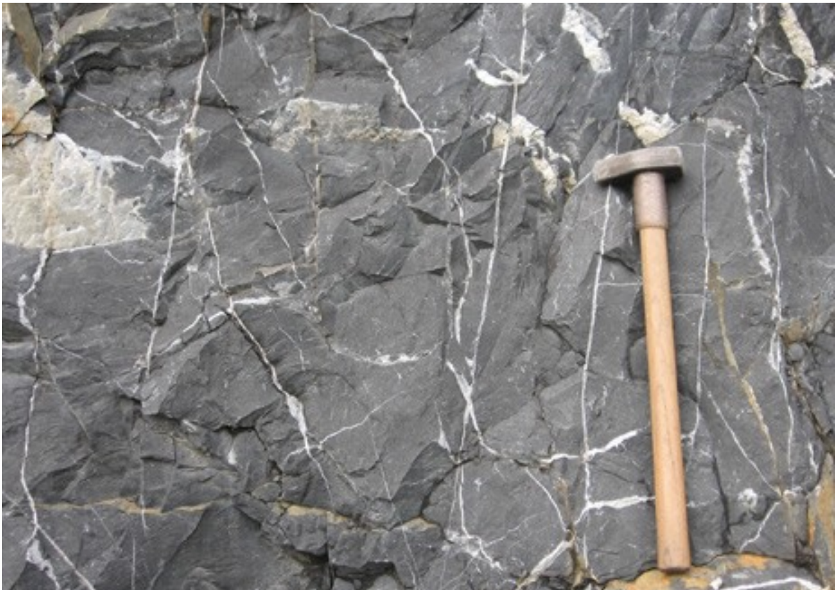
Abb. 16: Kompakter, kaum durch Zwischenschichten unterbrochener Kieselkalk im Steinbruch Zingel am Bürgenberg (Hammerlänge 60 cm)
