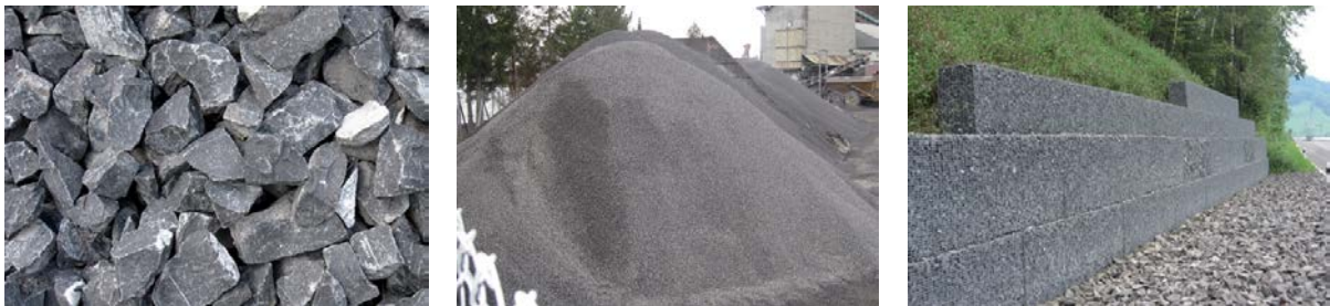
Abb. 18: Kieselkalk als Schotter für den Gleisoberbau (links), als Splitt für Deckbeläge von Strassen (mitte) und als Stützmauer aus Steinkörben, die mit Kieselkalk verfüllt sind (rechts)
